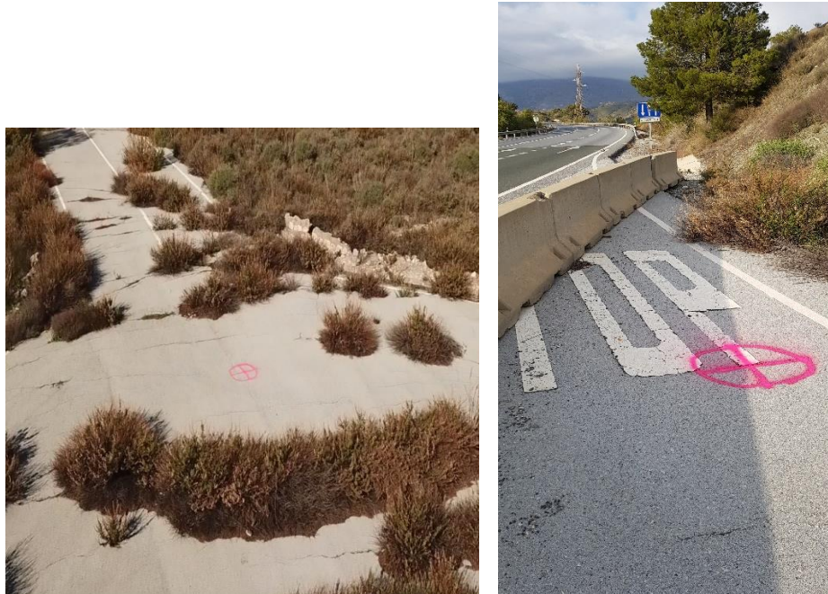
Figura 16. Dianas marcadas en el terreno para recalibrado del modelo 3D a su posición real.
