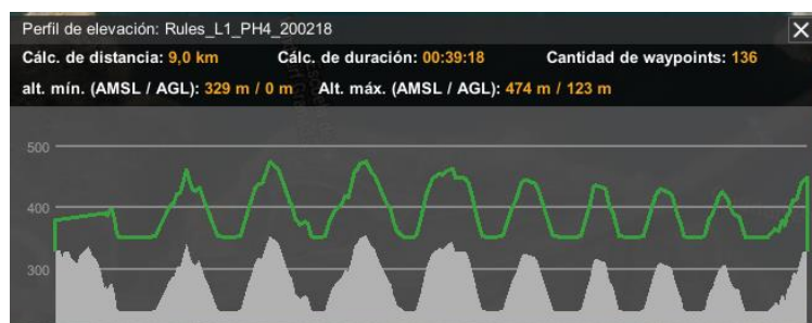
Figura 12. Perfil de elevación en el que se observa la altura del dron prevista para la ruta en cotas AMSL o AGL.
